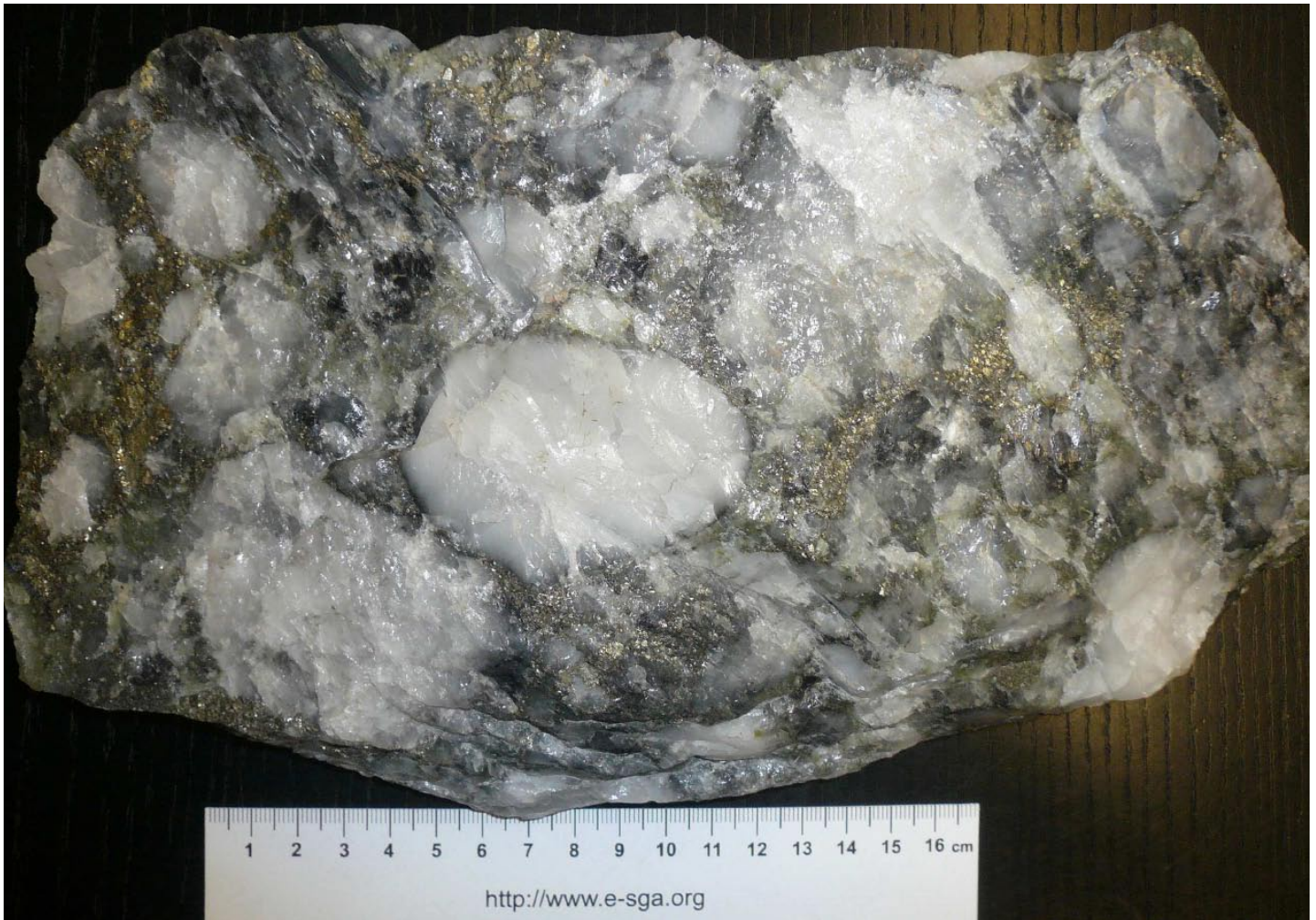
Abb. 12: Gold-Uran-Erz als Paläo-Seife (Meta-Konglomerat), Venterdorp Contact Reef, Witwatersrand, Südafrika. Dieses typische Handstück zeigt milchig-weiße Quarz-Kiesel in feiner Matrix aus Chlorit und Pyrit (gelblich). Uraninit und Gold sind nur im mikroskopischen Bild sichtbar. Der durchschnittliche Gehalt der 3,1 Ga-alten Witwatersrand Meta-Konglomerate liegt bei rund 10 g/t Au + 210 g/t U, während die sehr ähnlichen Paläo-Seifen im Blind River/Elliott Lake-Bezirk in Ontario, Kanada, etwa 900 g/t U führen, aber kein Gold enthalten. (Sammlung Lehmann).
